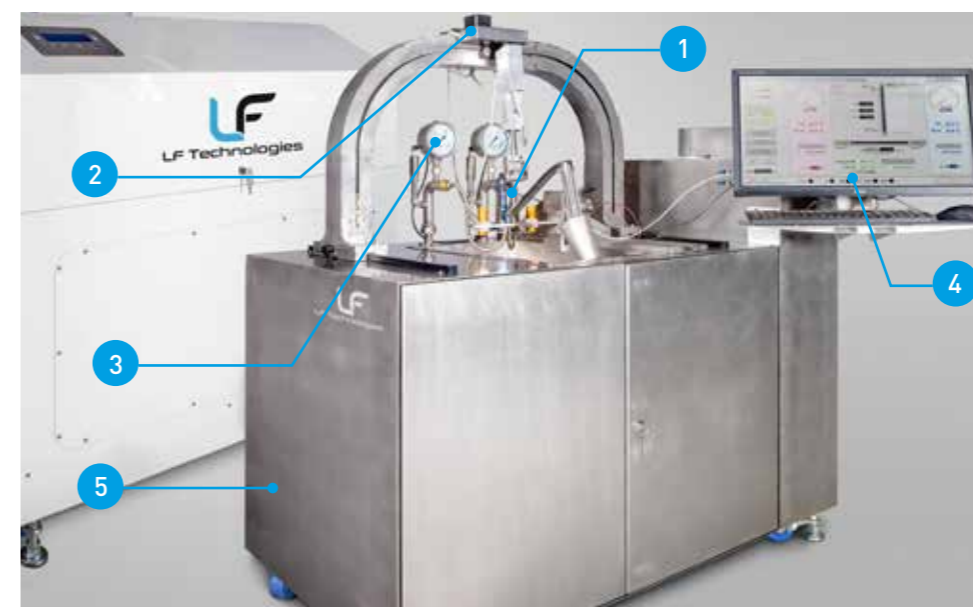
1 - Rubinetto in fase di test 2 - Attuatore rotante 3 - Misurazione della pressione 4 - Controllo PC 5 - Gruppo idraulico
